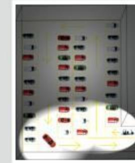
將主管LED tube初始亮度設置為30%或者全滅,當有人或車進入到感應區域時,主管接收到感應信號,亮度立即會調至全亮,僕管收到主管發出的信號,立即同步全亮。當人或車經過後,設定一段時間延時,主管變為30%或者全滅,僕管同步30%或者全滅。
