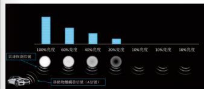
一、車輛進入地下車庫，雷達感應到A信號，亮度100%，同時發出無線信號(B信號)，通知附近相鄰的燈依次亮起60%,40%,20%亮度
